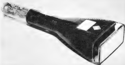
Bild 4. Die Telefunken-Oszillografenröhre D 8-11 besitzt einen rechteckigen Planschirm. Seine Fläche läßt sich daher gut zum Schreiben von Kurvenzügen ausnutzen
