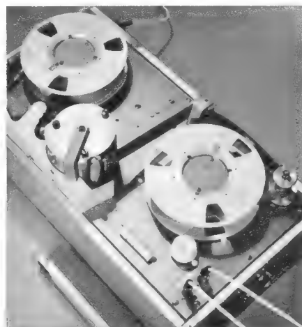
Bild 1. Die jetzige Version 3 des Video-Aufzeichnungsgerätes mit geringeren Abmessungen
