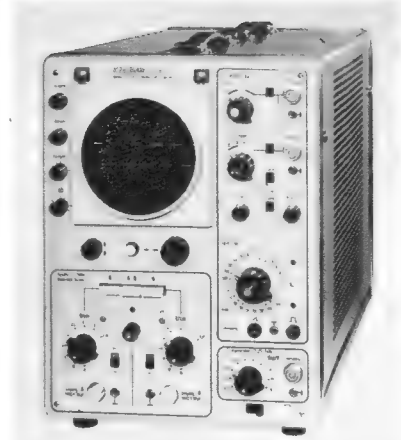
Rechts: Bild 7. Der Meßoszillograf OS-1 von Wandel u. Goltermann für eine Bandbreite bis 33 MHz arbeitet mit zwei getrennten Y-Eingängen
